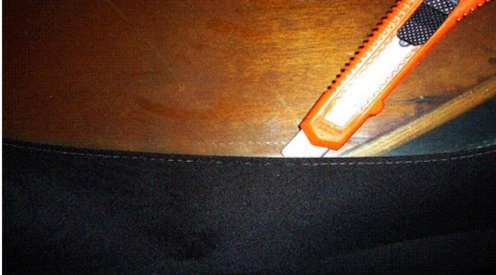
Sie fahren zwischen Scheibe und Verdeckstoff, ziehen das Messer an der Scheibe entlang und trennen somit die Naht, die die Scheibe hält auf.
